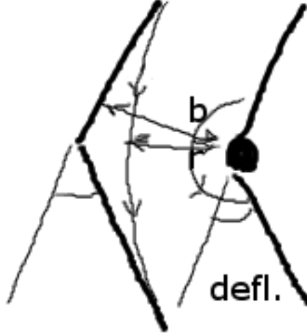
Figura 8.1: Orrenda figura che descrive la deflessione subita da un raggio di luce a causa dell'interazione gravitazionale con un corpo di grande massa; l'angolo di deflesione \Delta\phi = \Delta\theta - \pi dove \Delta\theta é l'angolo concavo che si ottiene ruotando in senso antiorario la direzione di v_{-\infty} fino a farla coincidere con v_{+\infty}
